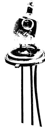
Abb. 6: Der Memistor, ein miniaturisierter variabler Widerstand (Fig. 8.12 aus [6]).
